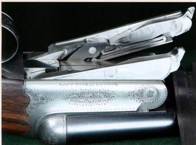
Современная двустволка серии Heritage с извлекаемыми замками системы «Тейлор и Дили» и унитарным спусковым крючком
